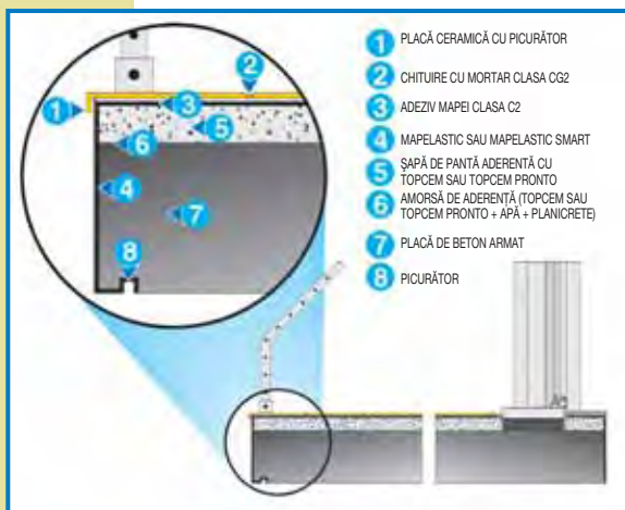
Detaliu: impermeabilizarea suprafeței unui balcon
